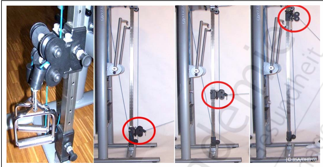
Abb. 2: Höhenverstellbare Umlenkrollen eines Seilzuges (©BSA/DHfPG)
